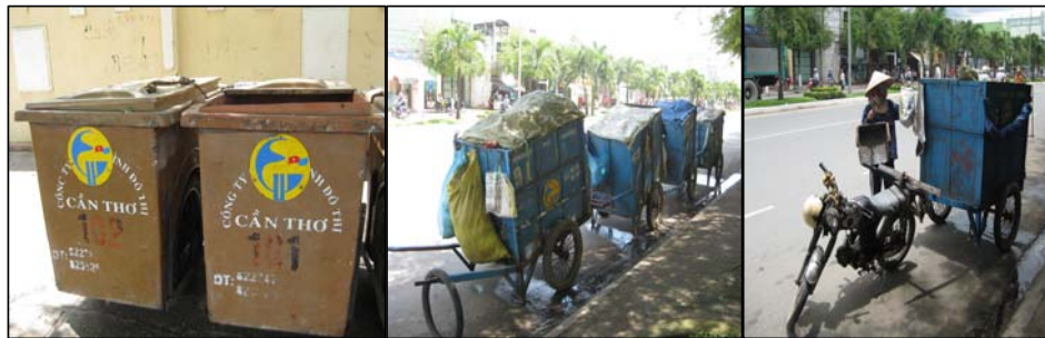
Hình 2: Các phương tiện thu gom chất thải rắn tại thành phố Cần Thơ (A) Xe đẩy tay (660L) – loại 1, (B) Xe kéo tay (1.000L) – loại 2, (C) Xe kéo có gắn động cơ (1.000L) – loại 3
